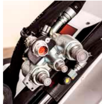
Circuit hydraulique auxiliaire
